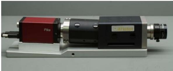
Figura 4. Cámara Pike F-210B acoplada al espectrógrafo V10E.
